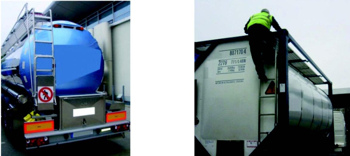
Abbildung 18: Aufstiegsmöglichkeiten bei bestimmten Lkw-Aufbauten [51]
