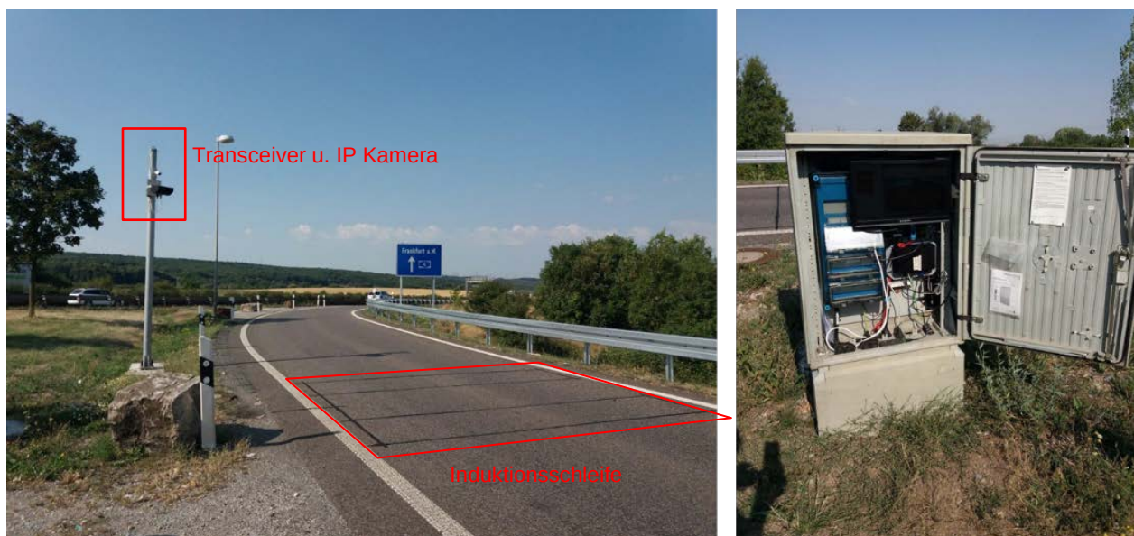
Abbildung 8: Links: Transceiver und IP-Kamera, Induktionsschleife. Rechts: Messrechner (inkl. Zusatz-Hardware) und Induktionsschleifendetektor.
